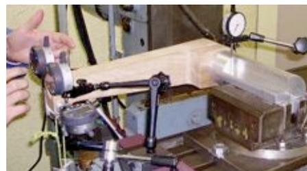
Figure 4. Essai de flexion sur un bras en hêtre
