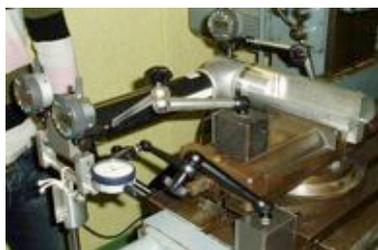
Figure 3. Essai de flexion sur le bras en carbone
