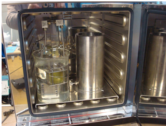
Figure 8. Montage pour l'étude de l'influence de la pression hydrostatique sur la reprise en eau de polymères et composites. A gauche, éprouvettes dans l'eau sans pression, à droite, caisson hyperbare (600 bar), l'ensemble dans un four à 60°C.
