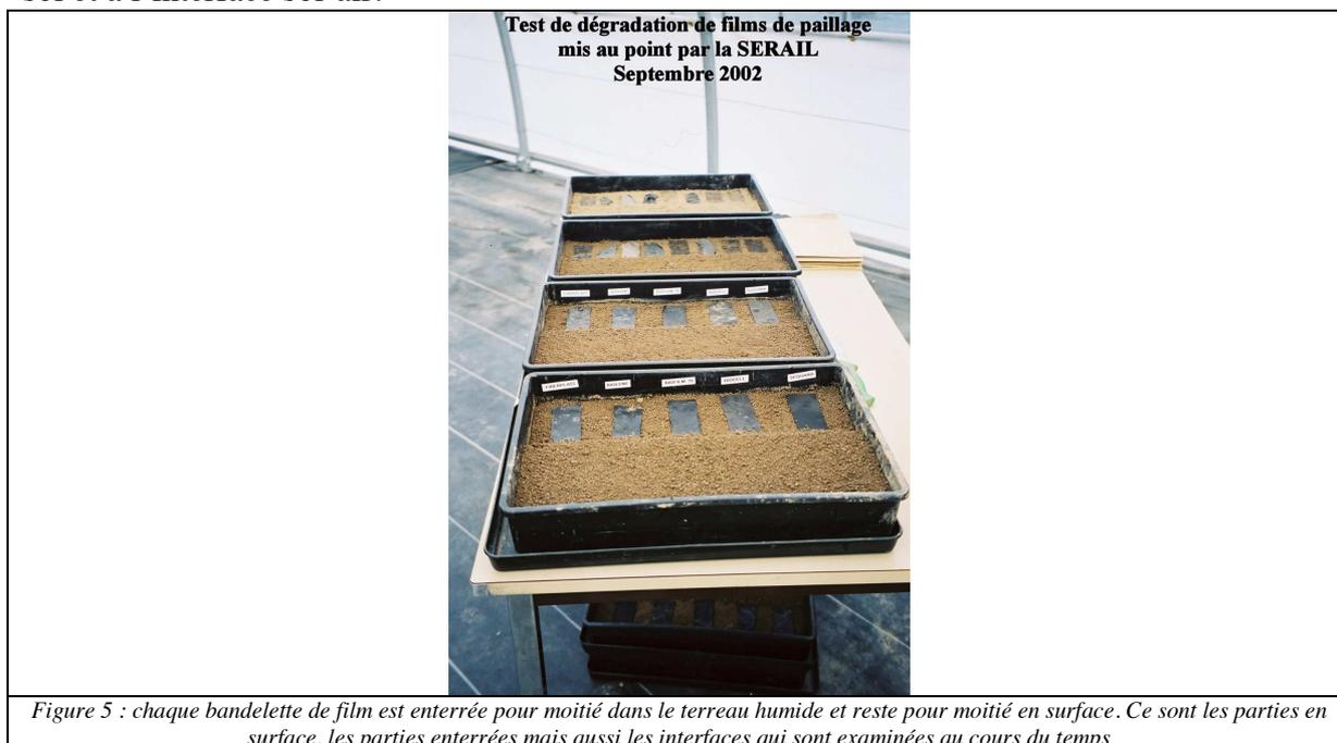
Figure 5 : chaque bandelette de film est enterrée pour moitié dans le terreau humide et reste pour moitié en surface. Ce sont les parties en surface, les parties enterrées mais aussi les interfaces qui sont examinées au cours du temps
