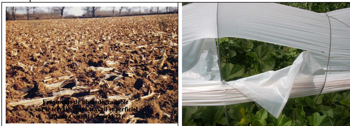
Figure 1 : Fragmentation de films plastiques de couverture (à droite PBAT-amidon) et de paillage (à gauche PE-amidon) utilisés en agriculture
