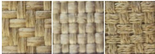
Figure 1. Structures des références testées (sergé 2x2, toile, hopsack 4x4)
