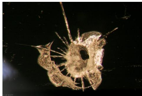
Figure 2. Endommagement produite par choc laser Ultra-court dans de la silice. (expérience 2013 sur Elfie – PIMM-PPRIME-LARMAUR- I2M-CEA)
