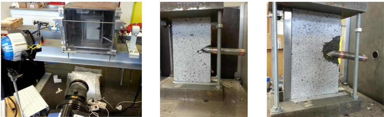
Figure 11. Essai de cratérisation par impact sur la tranche réalisé sur béton ultra-haute performance (Ductal®) : montage expérimental mis en œuvre au laboratoire 3SR et pénétration finale du projectile dans 2 cibles avec fibres orientées différemment ( $V_{impact} = 68$  m/s).
