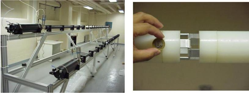
Figure 5 a) barre nylon  $\phi 60\text{mm}$  et  $\phi 40\text{mm}$  3+3m, b) mousse aluminium, c) rivets
