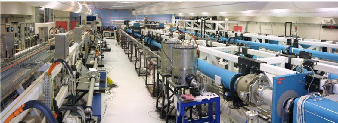
**Fig. 2.** Chaîne laser de LULI2000 ( $\sim 2 \text{ kJ}$ ), à l'École Polytechnique. Après amplification dans ce hall, le faisceau est acheminé vers des salles d'expériences équipées de grosses enceintes à vide et de divers marbres sur lesquels les chercheurs installent leurs moyens de mesures.
