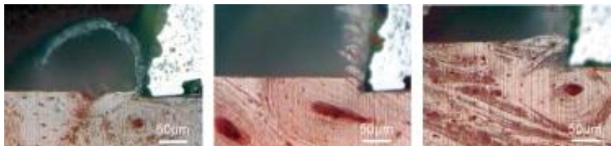
Figure 5: Usinage d'os utilisant différentes avances de coupe (10, 50, 80 \mu\text{m} ) [18]
