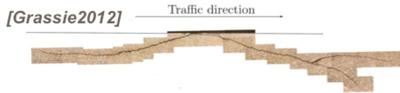
Figure 2.14. Interaction des fissures en fatigue de roulement (observation expérimentale)
