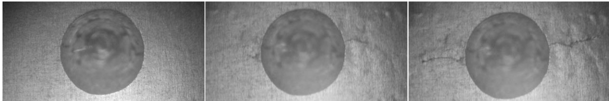
Figure 2. Exemple de suivi de fissure (de gauche à droite : cycles 0, 60 000, 100 000)
