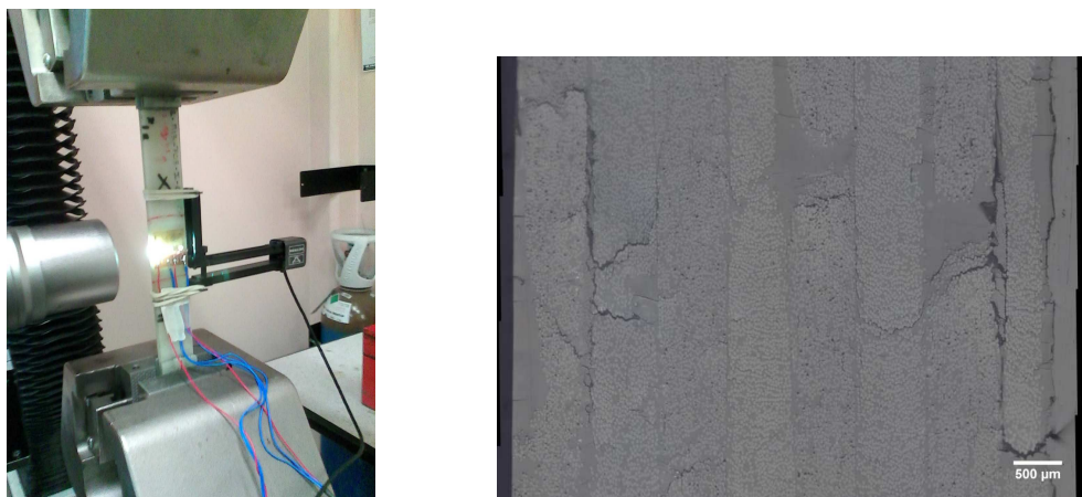
Figure 2. Observation au microscope des endommagements sur la tranche d'une éprouvette [ \pm 45^\circ ] soumise à un chargement de traction quasi-statique correspondant à une déformation de 2.2%
