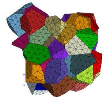
FIG. 7 – Maillage d'un agrégat polycristallin à 50 grains et 25000 noeuds
