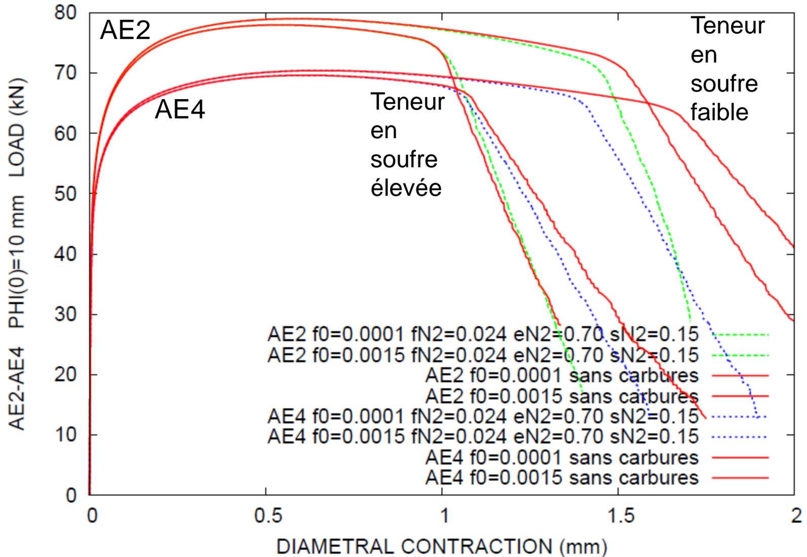
Propagation de la fissure (**AE4**, **MnS**  $f_0=0.0001$ )
