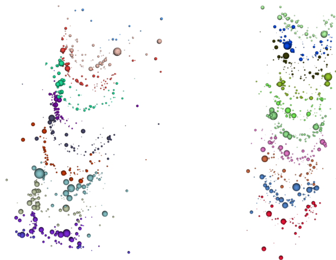
FIGURE 3 – Représentation de populations de défauts dans des joints soudés : données expérimentales (à gauche, les défauts sont représentés par leur sphère équivalente) et données simulées (à droite).
