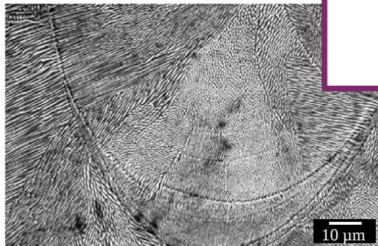
Cellules de solidification et cellules de dislocation l'acier 316L brut de LBM
