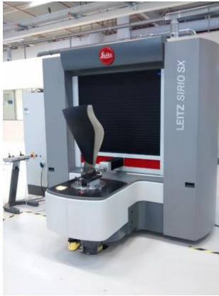
La pièce est placée dans un mors et palpée sur le pied et la pale
