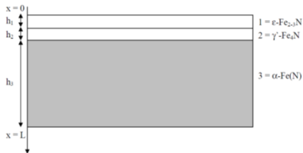
Figure 17 – Système en couches avec les phases de nitrures, attendues et observées
