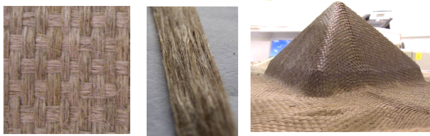
Fig. 1. (a) renfort tissé de lin. (b) Mèche extraite du renfort. (c) Préforme réalisée.
