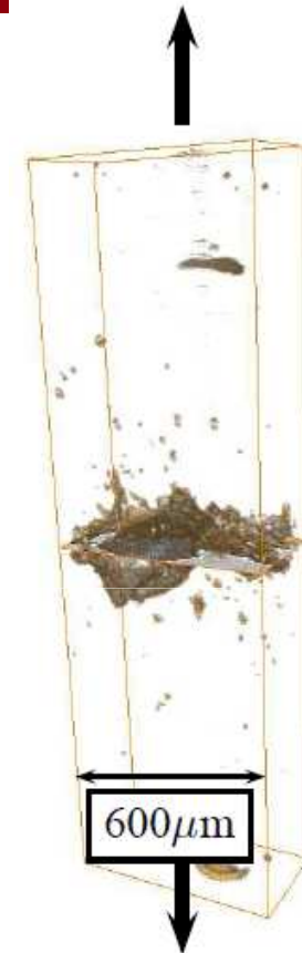
Observation du développement de l'endommagement par tomographie RX lors d'un essai de traction . Acier 16MND5 [Tanguy]
